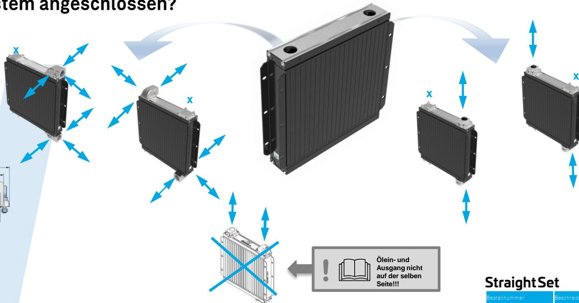
Alle rail Anschlüsse sind auf allen rail Kühlern (in der 3-Löcher Konfiguration) frei kombinierbar.
